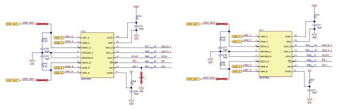
Figure 21. ADS7854 Circuit
