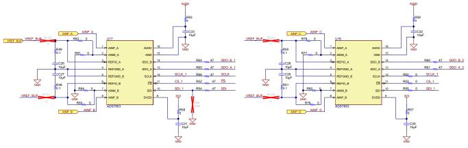
Figure 20. ADS7853 Circuit
