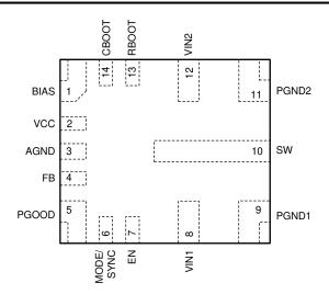
Figure 4-2. Pin Diagram: LMQ62440-Q1
