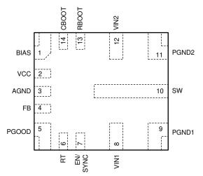
Figure 4-1. Pin Diagram: LMQ61460, LMQ61460-Q1
