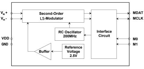
Figure 1. ADS1202 Block Diagram
