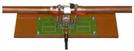
Figure 30. Capacitance matching
