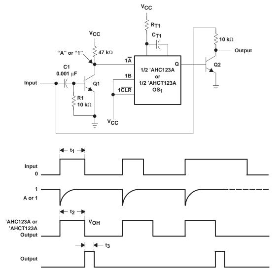
Figure 13. Pulse-Duration Detector
