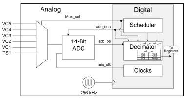
Figure 2. 14-Bit ADC System
