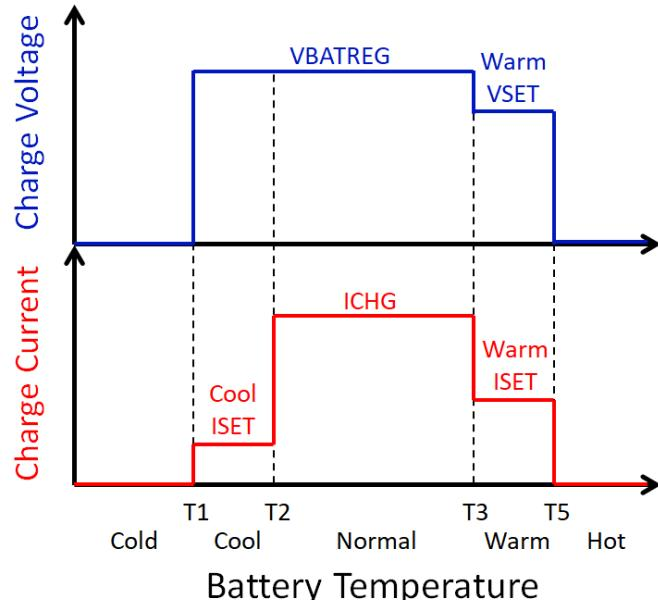
**Figure 3. BQ25619 Adjustable JEITA Temperature Profile**
