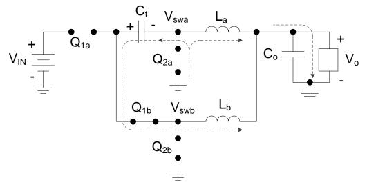
Figure 7. Interval 3: Phase B High Side Switch (Q1b) on
