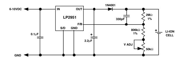
FIGURE 7. SINGLE CELL LI-ION CHARGER
