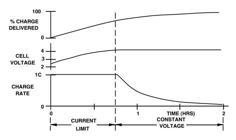
FIGURE 5. TYPICAL C-V CHARGE PROFILE
