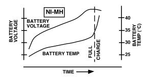
FIGURE 2. V/T PLOTS FOR 1C CHARGE RATE
