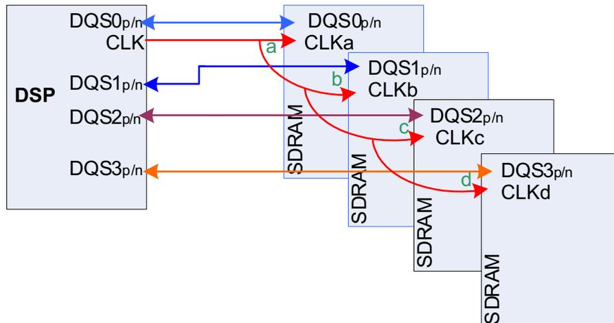
**Figure 6-4. DDRCLKOUT and DQ/  $\overline{\text{DQS}}$  Routing From the DSP to SDRAMs**
