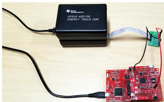
**Figure 26. CC3120 Device Test Setup With XDS110 System**
