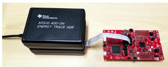
**Figure 27. CC3220 Device Test Setup With XDS110 System**
