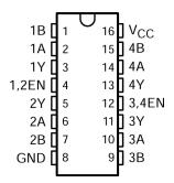
Figure 4-1. D, N, or NS Package (Top View)
