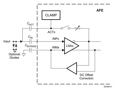
Figure 99. LNA Input Configurations
