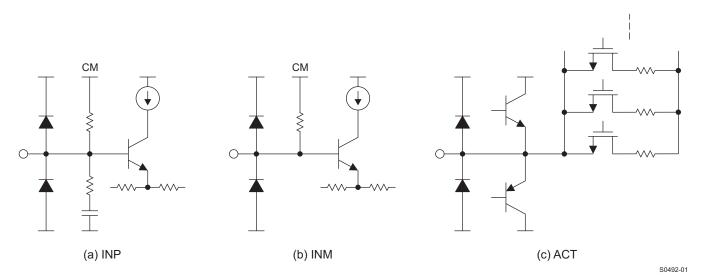
Figure 77. Equivalent Circuits of LNA Inputs
