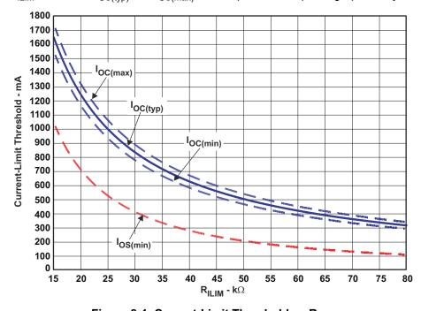
Figure 8-1. Current-Limit Threshold vs R<sub>ILIM</sub>
