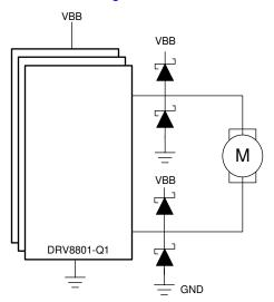
Figure 8-9. Schottky Diodes Connection
