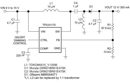
Figure 19. 12-V SEPIC (Buck-Boost) Converter
