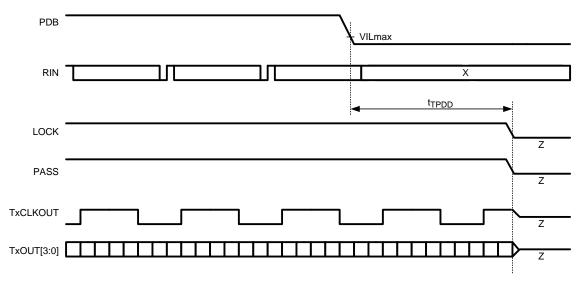
Figure 5. FPD-Link & LVCMOS Powerdown Delay
