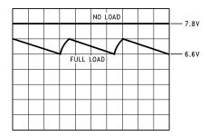
Figure 37. V<sub>IN</sub> VOLTAGE WAVEFORMS
