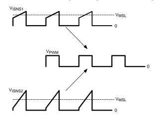
Figure 20. Pulse-Level Transformation
