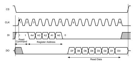
Figure 24. SPI Interface Read
