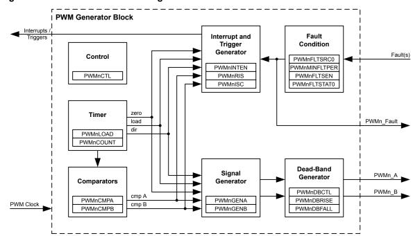
Figure 16-2. PWM Module Block Diagram
