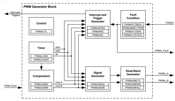
Figure 14-2. PWM Module Block Diagram
