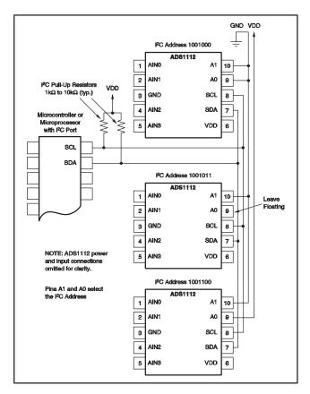
Figure 5. Connecting Multiple ADS1112s
