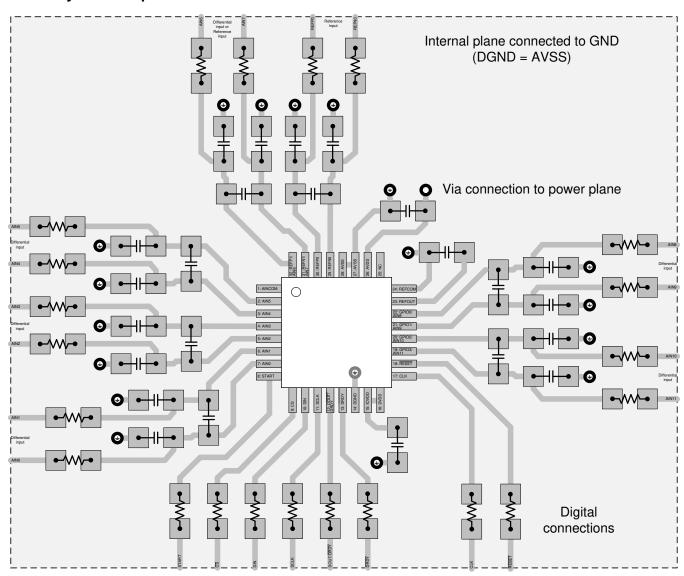
Figure 104. ADS114S0xB Layout Example
