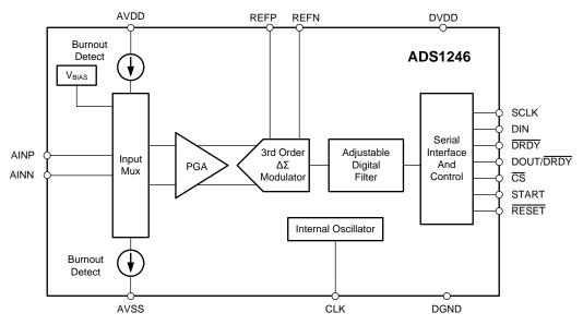
Figure 49. ADS1246 Block Diagram
