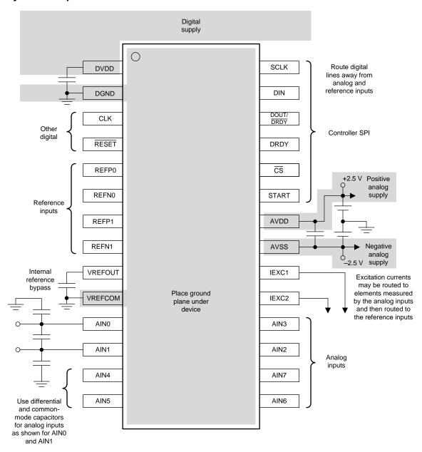
Figure 124. ADS124x Layout Example
