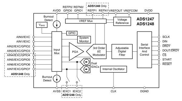
Figure 50. ADS1247, ADS1248 Block Diagram
