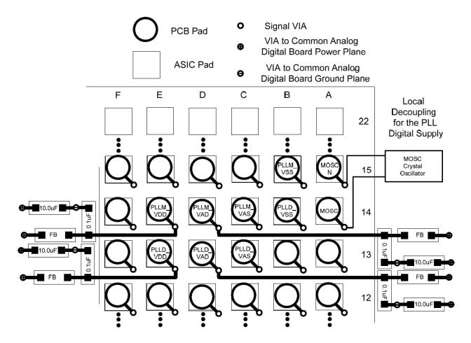
Figure 27. PLL Filter Layout
