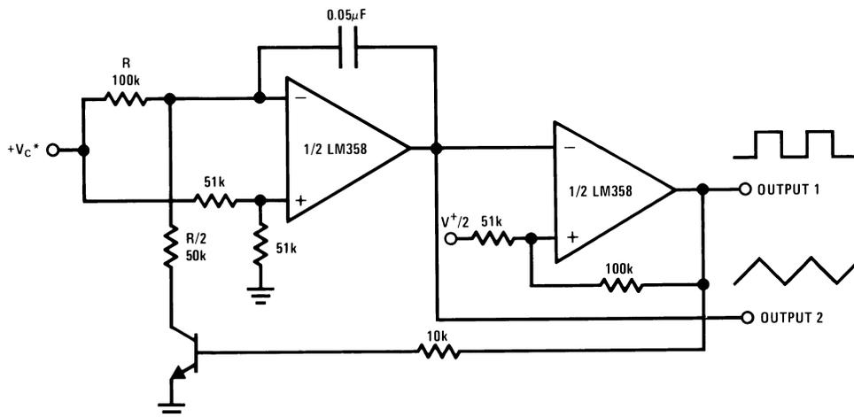
\*WIDE CONTROL VOLTAGE RANGE:  $0 V_{DC} \leq V_C \leq 2 (V^+ - 1.5V_{DC})$
