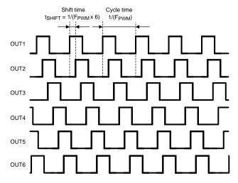
Figure 14. Phase Shift PWM Mode
