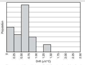
Figure 12. Offset Voltage Drift Production Distribution
