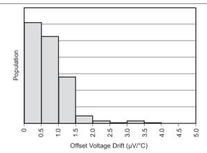
Figure 6-3. Offset Voltage Production Distribution
