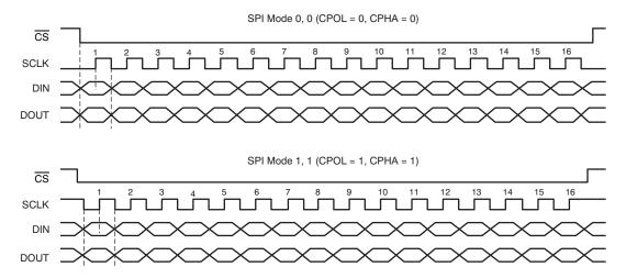
Figure 56. SPI Mode 0,0 And Mode 1,1
