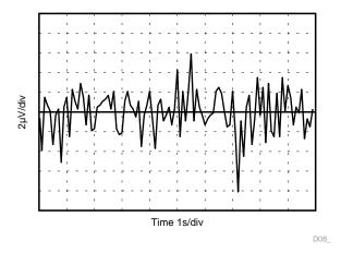
Figure 26. 0.1-Hz to 10-Hz Noise (V<sub>REF</sub>)
