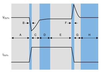
Figure 8-9. Load Transient Waveform
