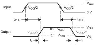
VOLTAGE WAVEFORMS PROPAGATION DELAY TIMES
