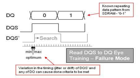
Figure 4. Read DQS to DQ Eye Training - Failure Mode
