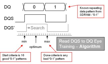
Figure 3. Read DQS to DQ Eye Training - Algorithm
