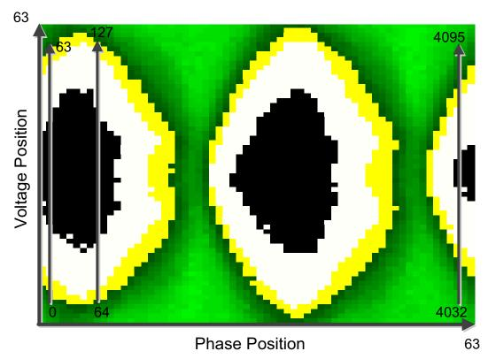
Figure 14. EOM Full Eye Capture Readout
