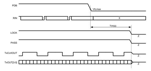
Figure 5. FPD-Link & LVCMOS Powerdown Delay
