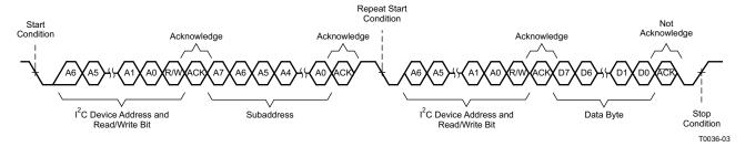
Figure 30. Single-Byte Read Transfer
