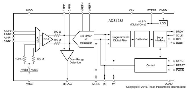
Figure 1. ADS1282-SP Block Diagram
