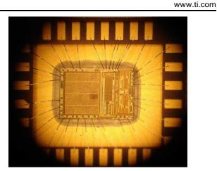
Figure A-1. De-processed ADS1282 DUT
