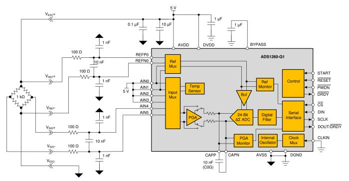
Figure 4. Implementation of an OBW System Using ADS1260-Q1
