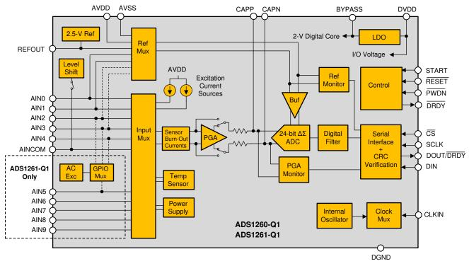
Figure 3. ADS1260-Q1 and ADS1261-Q1 Block Diagram
