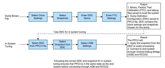
Figure 2. End-System Integration Workflow
