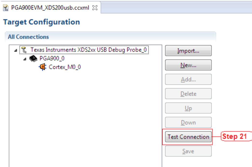
Figure 16. XDS200 USB Emulator Test Connection
