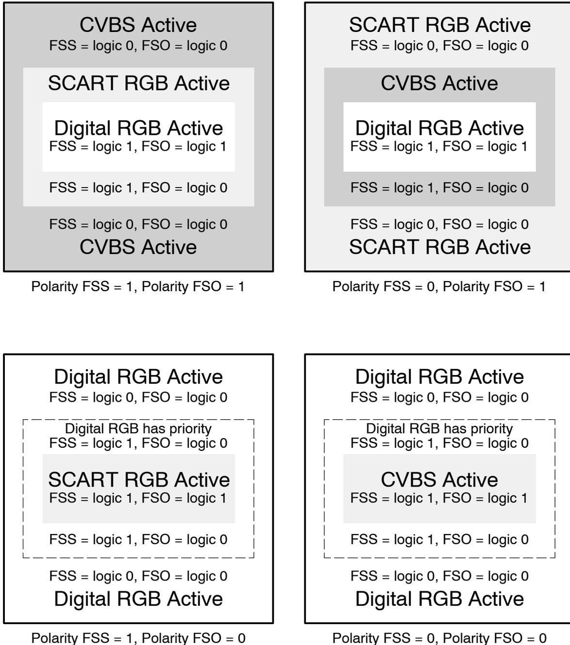
**Figure 8. Fast-Switch Mode 003 [(CVBS ↔ SCART) ↔ Digital Overlay]**
