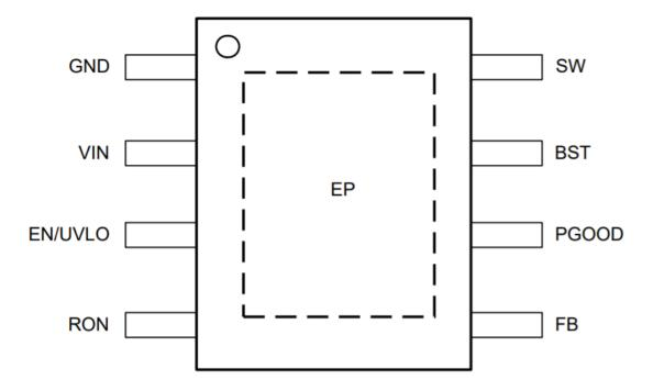
Figure 4-1. Pin Diagram
