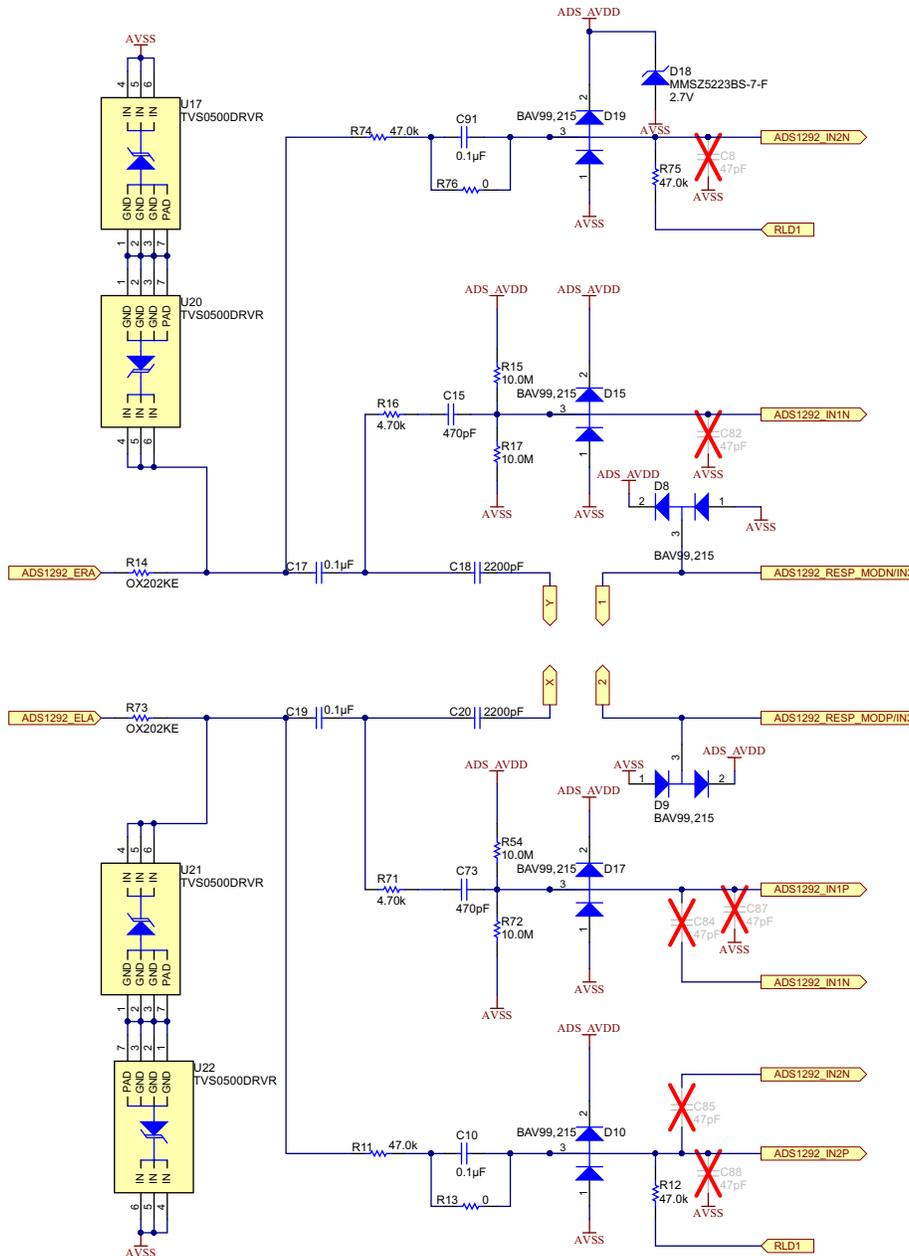
Figure 4. ECG Subcircuits – ADS1292R and RLD
