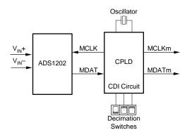
Figure 3. CDI Circuit Interfacing ADS1202
