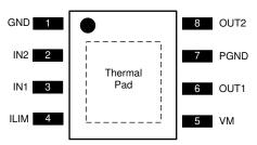
Figure 4-1. Pin Diagram
