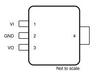
Figure 4-1. Pin Diagram
