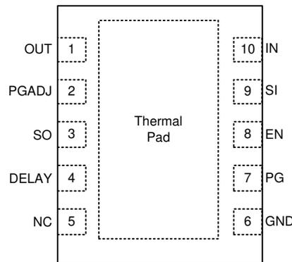
**Figure 4-1. Pin Diagram**
